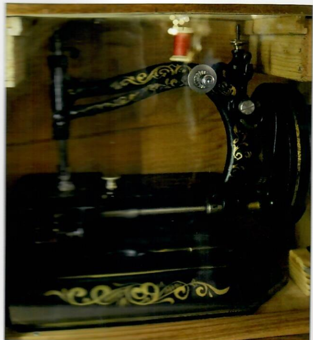
Nähmaschine von E. Westhäuser in Stuttgart. Bei der Maschine kann der Kettenstichgreifer nach Gibbs gegen einen Umlaufgreifer nach Wilson getauscht werden.
